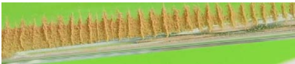
Abb. 08: Korkmehl und stehende Wellen in einem akustischen Rohr, Anregung über einen Lautsprecher rechts. Das Mehl bleibt dort liegen, wo die Luftteilchen kaum in Bewegung sind. Es bilden sich scharfkantige Haufen. Schaltet man die Anregung ab und klopft auf das Rohr, fallen die Haufen zusammen, das Mehl verteilt sich wieder.
