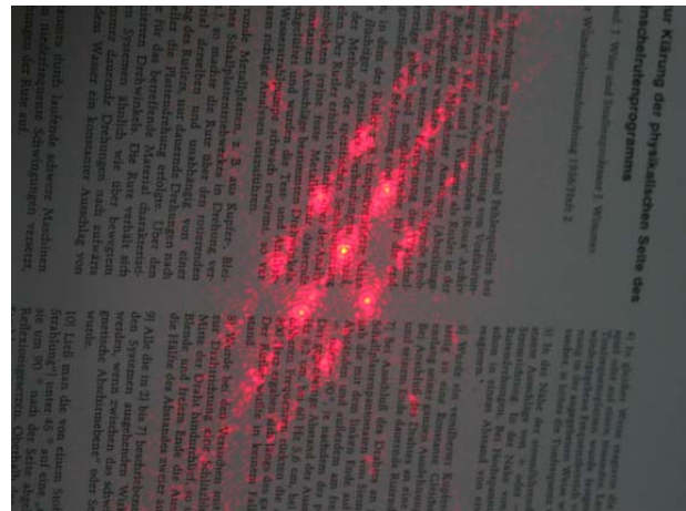
Abb. 02: Laserstrahl durchleuchtet ein dünnes Seidentuch. Es entsteht in einigen Metern Entfernung ein gut sichtbares, komplexes Beugungsbild (Interferenzbild). Die Anordnung der Punkte und deren Lichtverteilung erlaubt eine Aussage über die Geometrie der Maschen und Fäden des Tuches sowie zur Symmetrie des Gewebes. Eine graphische Manipulation der Position eines Punktes würde man sofort als Fehler entlarven können, wenn dadurch die Symmetrie verletzt wird. /Balck: gitter-beugung.htm/
